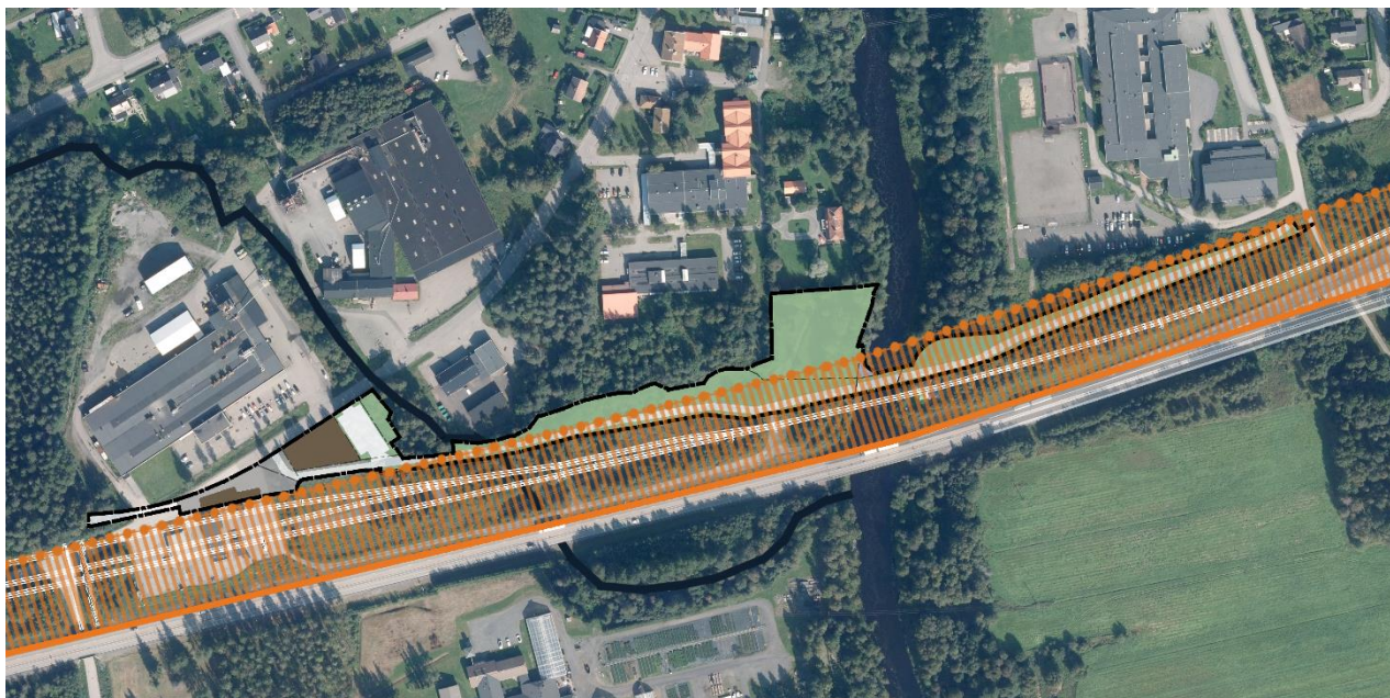
Figur 42. Illustration som redovisar väggkant för E4:an med orange heldragen linje. Illustrationen redovisar även ett 55 meter säkerhetsavstånd från vägen med prickad orange linje samt svag orange skraffering.
