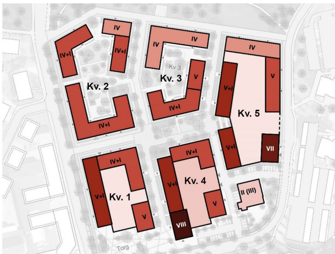
Figur 16. Planområdet är utformat som kvartersstad med våningsantal mellan fyra och sex våningar samt två punkthus på sju resp. nio våningar. I planbeskrivningen refereras till kvarter 1-5, se ordningsföljd ovan. Illustration gjord av Strategisk Arkitektur
