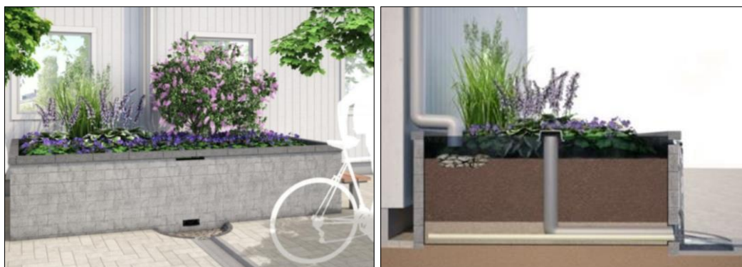
Figur 15. Exempel på upphöjd växtbädd som tar emot dagvatten från tak via stuprör
