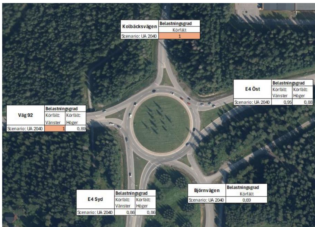
Figur 11. Beräknade belastningsgrader för samtliga anslutningar i Nydalarondellen för utredningsalternativet 2040. Källa: Trivector Traffic
