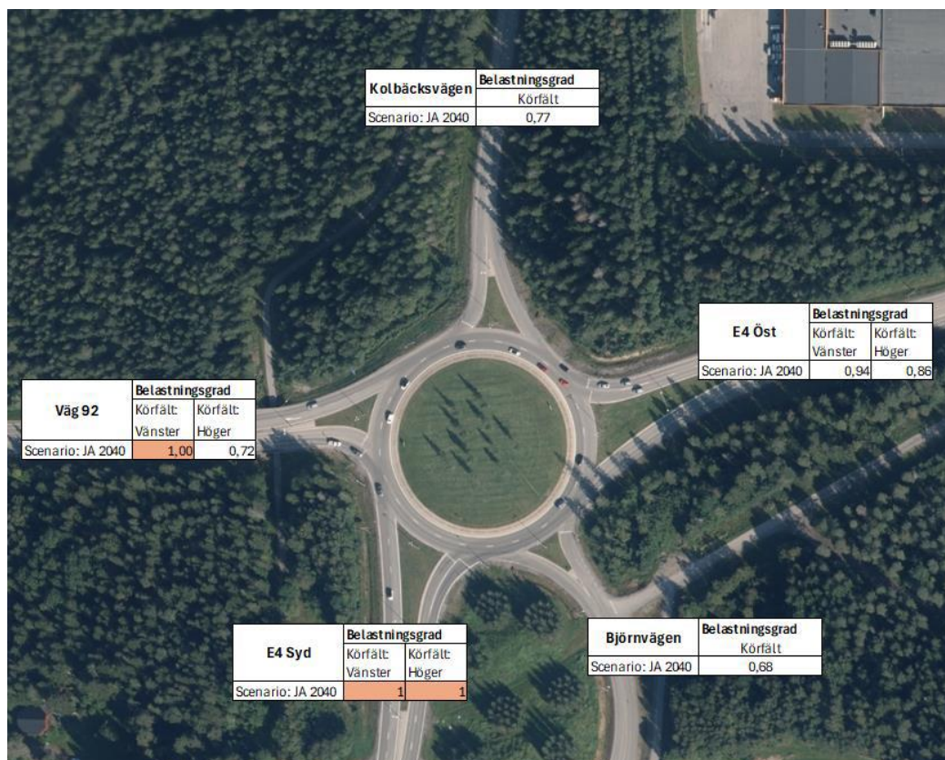
Figur 10. Beräknade belastningsgrader för samtliga anslutningar i Nydalarondellen för jämförelsealternativet 2040. Källa: Trivector Traffic
