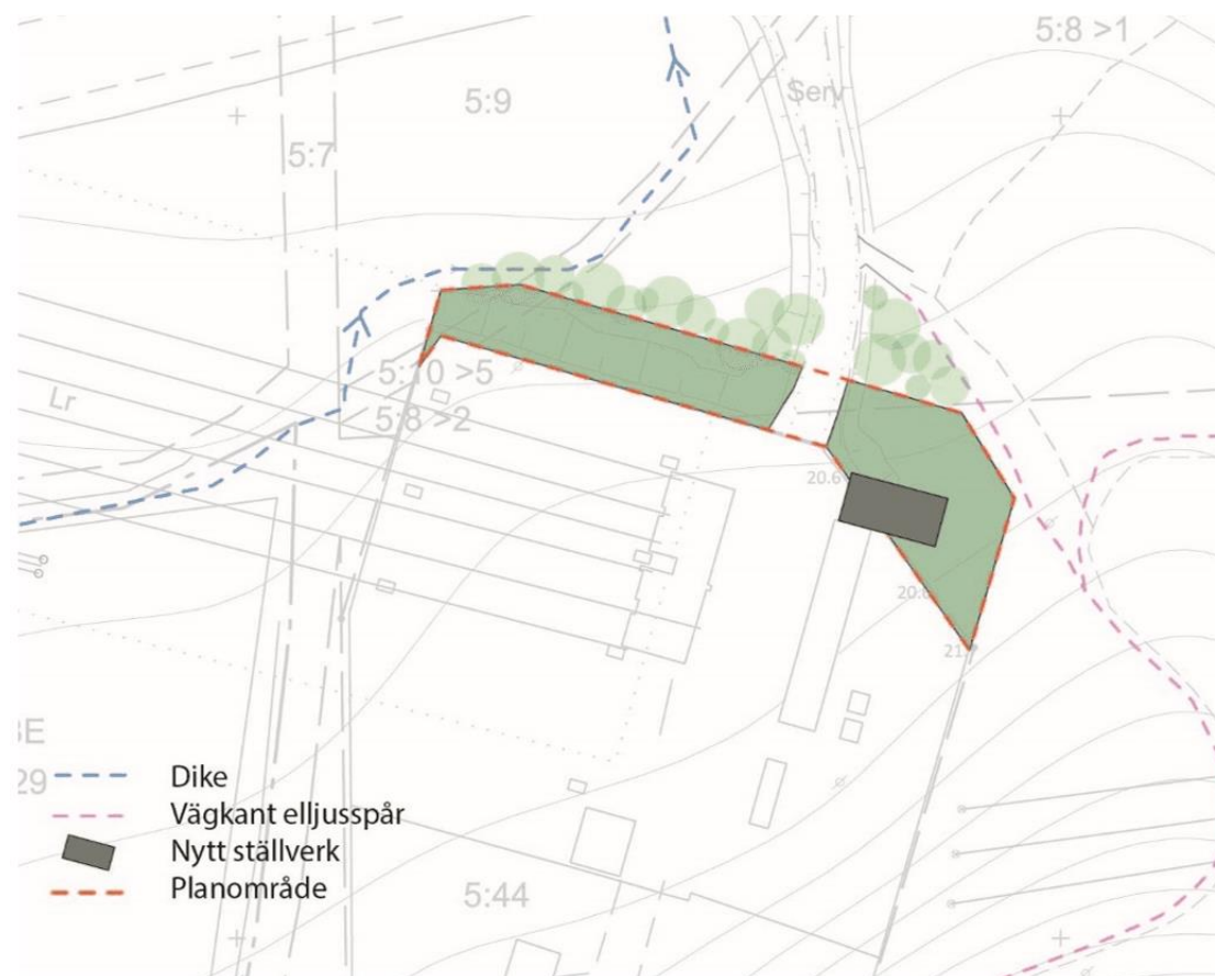
Figur 15: Situationsplan som visar möjlig placering av den tillkommande byggnaden gällande 12 kV ställverket samt hur planförslaget förhåller sig till befintligt elljusspår och dike.
