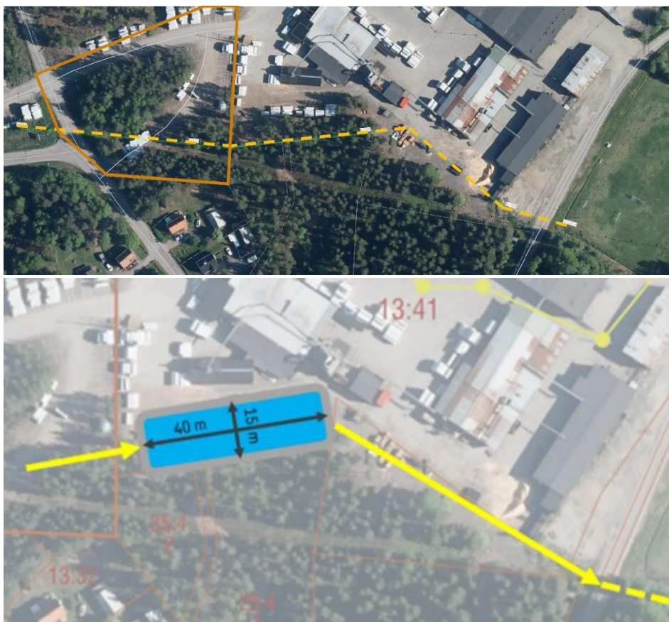
Figur 21. Schematisk principskiss för förslag av omledning av dagvattnet från det befintliga industriområdet över Pålboletomten 8:1 och Sävar 13:41. Källa: Sweco
