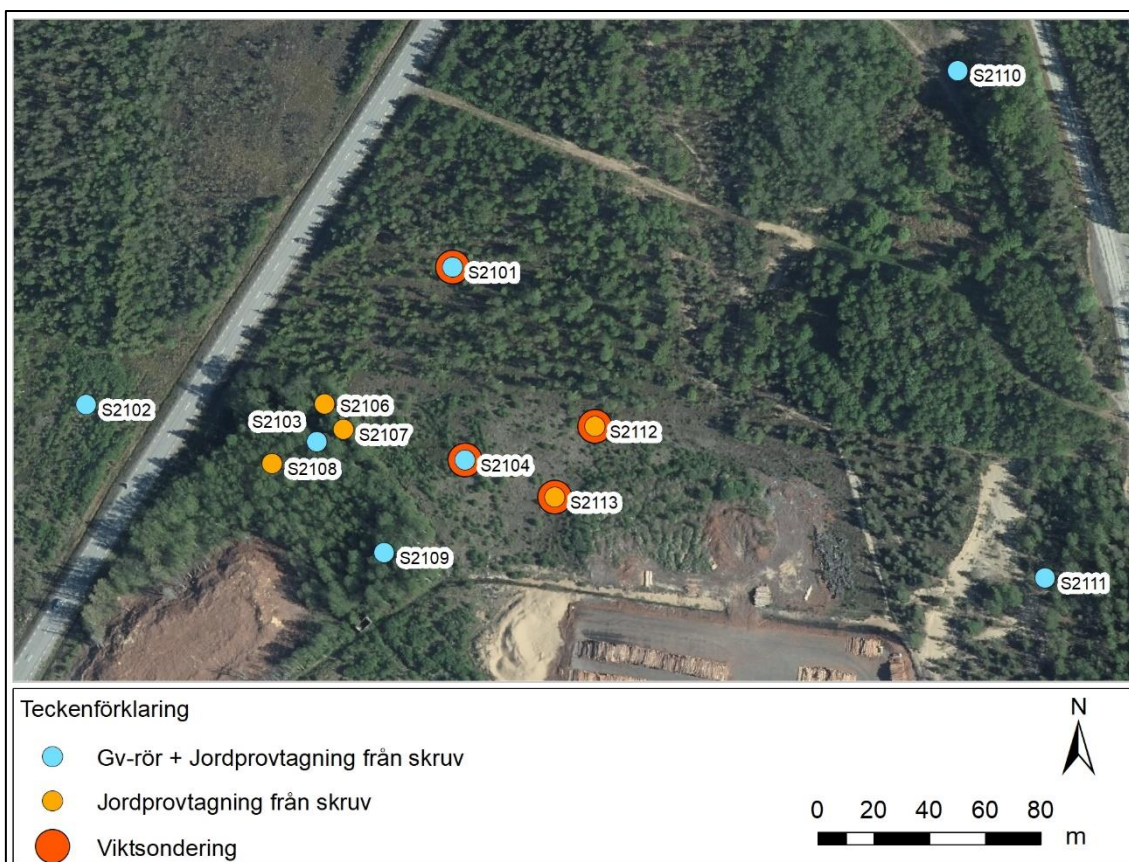
Figur 3: Undersökningspunkter för installation av grundvattenrör samt jordprovtagning.
