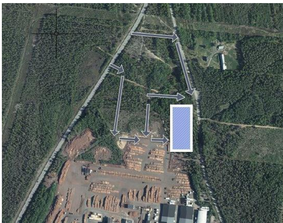
Figur 19. Dikessystem (pilar) och dagvattenanläggning (blå ruta) för det norra delen av planområdet. Källa: Sweco, bearbetning Umeå kommun.
