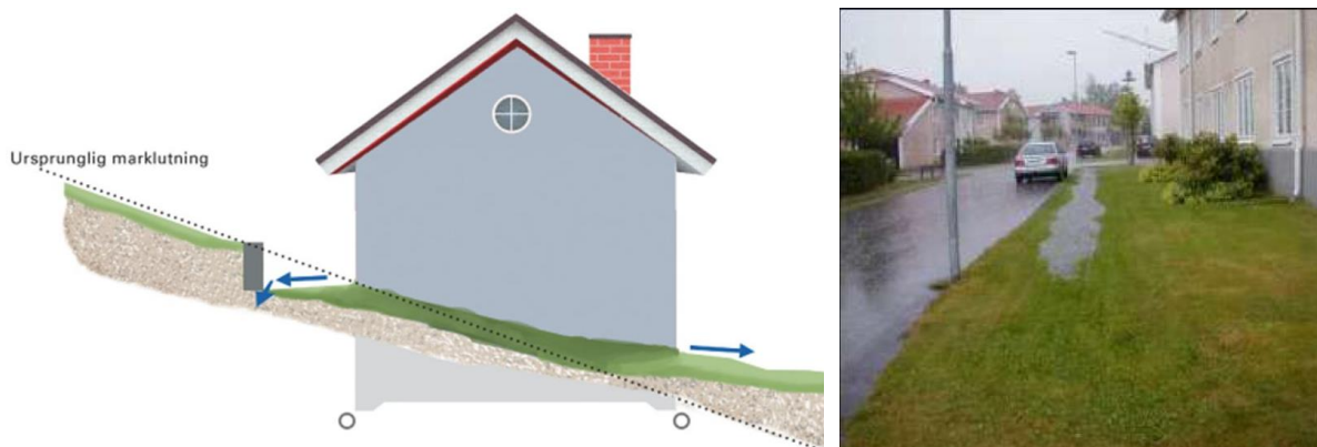
Figur 20. Till vänster: Principskiss över hur vatten lämpligtvis avleds från ett hus byggt på en sluttande markyta. Bildkälla: Hållbar dagvattenhantering, Edsviken vattensamverkan 2016. Till höger: Sluttande grönyta för att omhänderta dagvattnet (Svenskt vatten P105).
