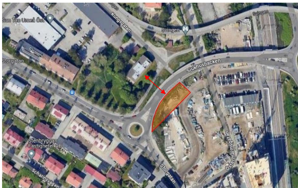
Figur 10 Illustration över byggrätten mot Sjukhusbacken i detaljplanen för Kv Uttern med bygghöjd 39 m ovan mark. Avstånd Mellan fasaden på befintlig byggnad i Kv Vipar och byggrätten i Kv Uttern är 35 – 36 m (röd pil).
