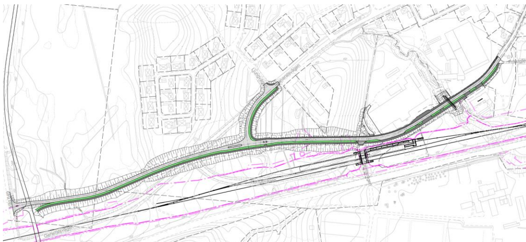
Figur 21. Utdrag ur illustrationskarta som visar Kungsvägens sträckning och funktioner utifrån detaljprojekteringen tillsammans med järnvägspanens markanspråk (ljuslila gränser).
