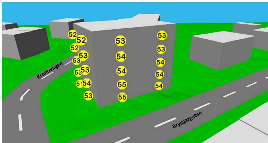
Figur 5. 3D-vy från syd över södra fasaden för framtida trafik. Dygnsekvivalent ljudnivå - L_{Aeq,24} dB (2040).
