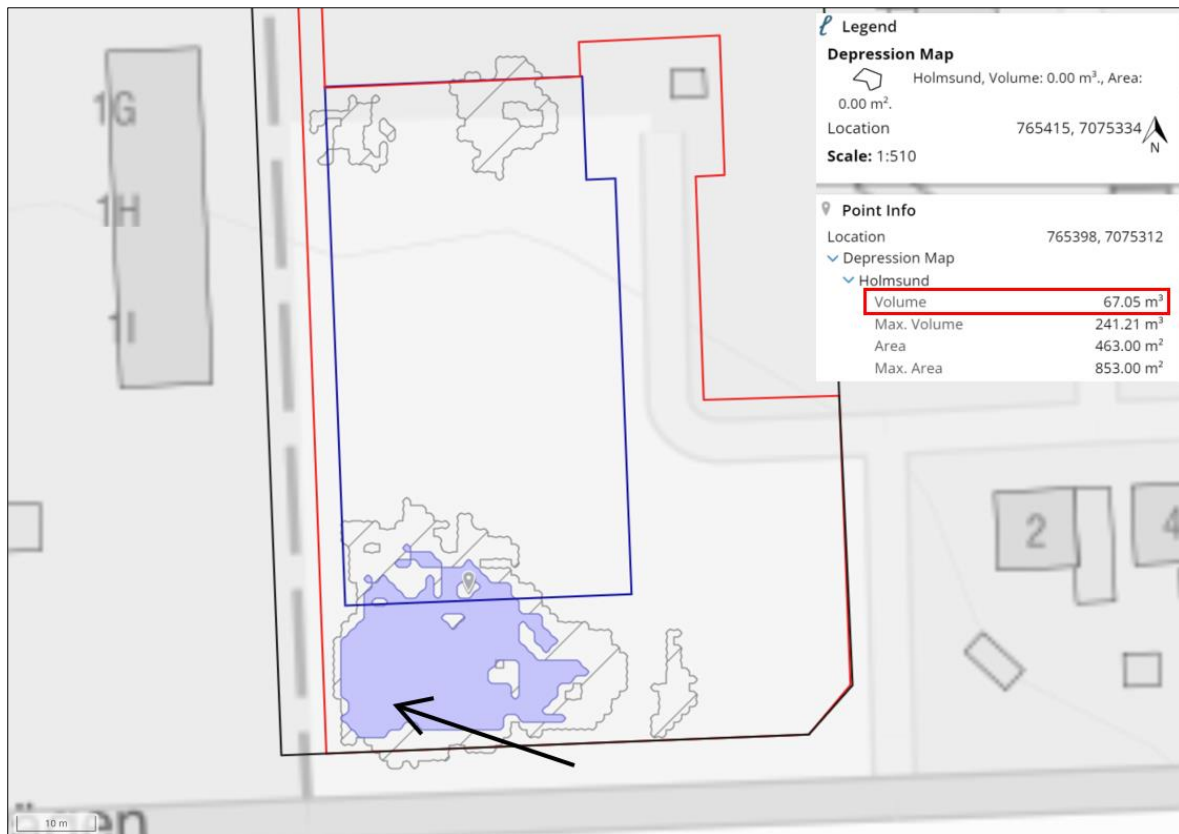
Figur 16. Vattenfylld sänka med en volym på 67 m 3 (lila område) (Scalگو Live, 2021). Planområdet är markerat med svart linje, utredningsområdet är markerat med röd linje och gränsen mellan kvartersmark och allmän platsmark är markerade med blå linje. Svart pil illustrerar planområdets lågpunkt (+12,9).
