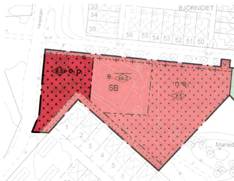
Visar den korsmarkerade ytan som är avsatt för angöring för biltrafik till förskolan samt varutransporter.
