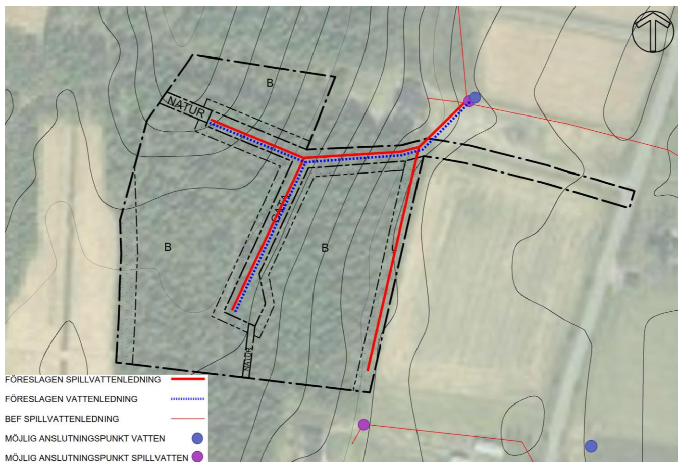
Figur 7. Föreslagen ledningsdragning för VA-försörjning till planområdet.
