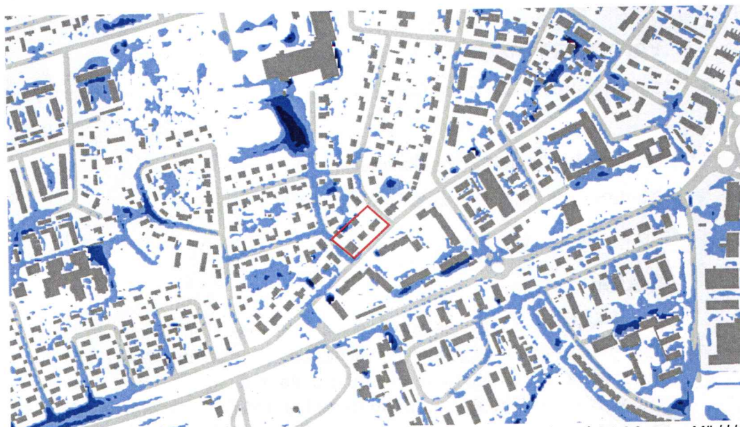
Maximalt vattendjup vid ett eventuellt 100 års-regn. Ljusblå färg motsvarar vattendjup på 0,1-0,3 meter. Mörkblå färg motsvarar vattendjup på 0,3-0,5 meter. Planområdet markeras ungefärligen med rött.
