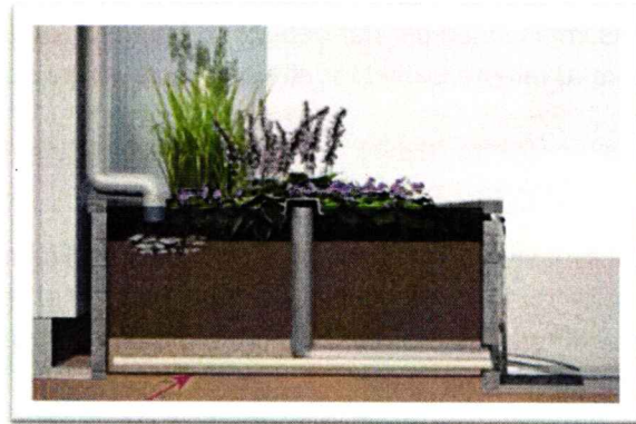
Figur 33. Till höger: Exempelbild på regnbädd anpassad för att passa in i stadsmiljö. Bildkälla: Movium 2, 2015, illustration: Tengbomgruppen. Till vänster: Principskiss över en regnbädds funktion i profil. Regnbädd "typ 4" med tät duk. Bildkälla: Movium 2, 2015, illustration: Tengbomgruppen.
