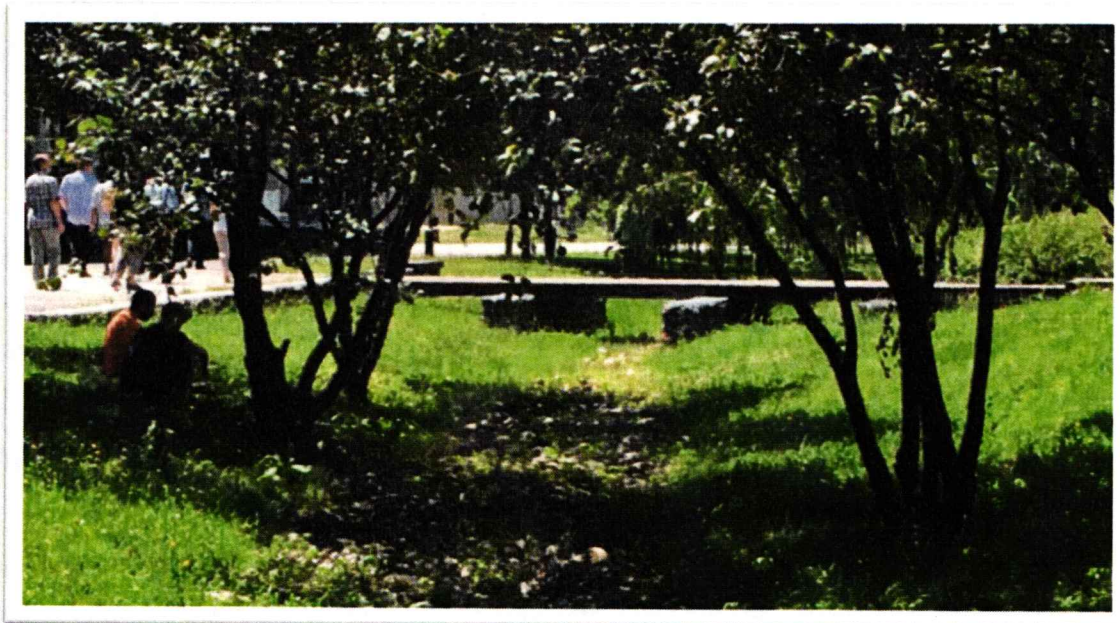
Figur 30. Exempel på översvämningssbara ytor. Översvämningssbara ytor står i regel tomma vid normalväder, men fylls i samband med stora regnhändelser. Bildkälla "Gröna dagvattenstråk" av LTU Dag&Nät, Grön Nano m.fl.
