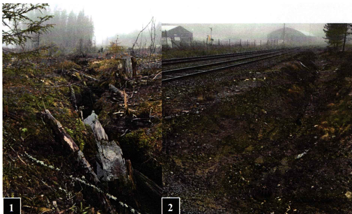
Figur 10. Bilder tagna på det planerade industriområdet. Bild 1 visar Lillbäcken som går igenom Industriområdet. Bild 2 visar dike längs järnvägen. Förslag finns att dra runt det befintliga krondiket som går igenom industrifastigheten idag till att gå i detta dike istället.
