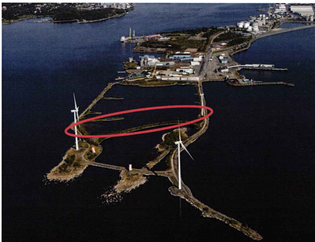
Figur 6-2. Område för utfyllnad i Lagunen med massor från etapp Öster (Umeå Hamn, 2019).
