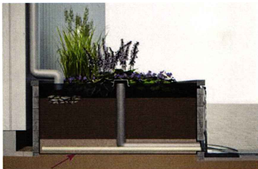
Figur 12. Principskiss över en regnbädds funktion i profil. Regnbädd "typ 4" med tät duk. Bildkälla: Movium 2, 2015, illustration: Tengbomgruppen.
