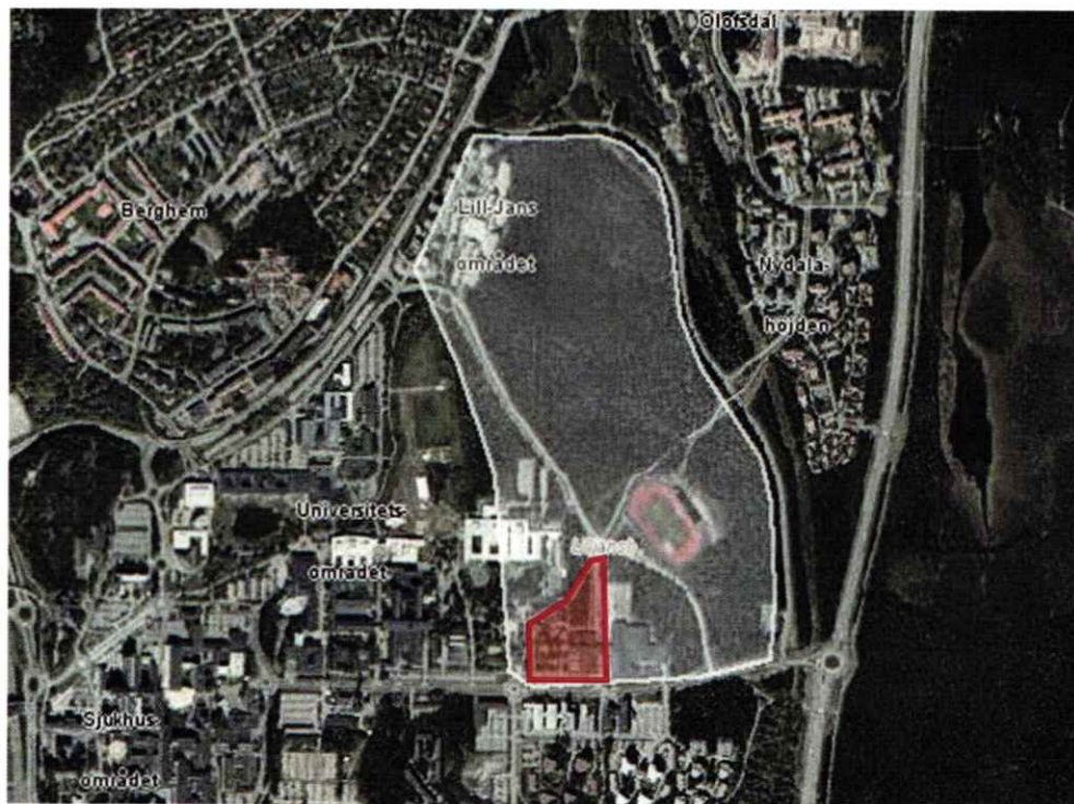
Figur 12. Illustration av området (vit markering), där byggnader med en totalhöjd på +70 meter över nollplanet kan tillåtas. Planområdet är markerat i rött. Bilden kommer från samordningsarbetet mellan Umeå kommun och Swedavia.
