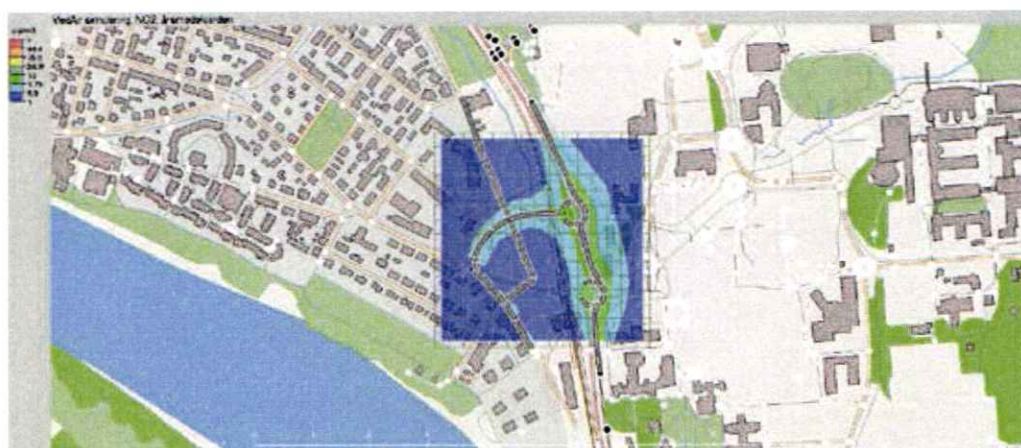
Figur 3, Visar årsmedelhalter av NO2 för beräkningsår 2015 och med det framtida emissionsscenariot. Nivåerna på skalan ska korrigeras med 0,9, ingen tröskel överskrids.
