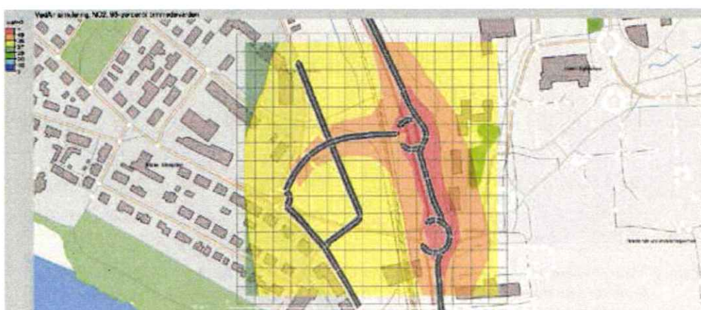
Figur 8, Visar 98-percentiler av timmedelhalter för NO 2 för beräkningsår 2010 med det framtida emissionsscenariot. Nivåerna på skalan ska korrigeras med 2.0, det finns områden där normen överskrids längs Blå vägen.
