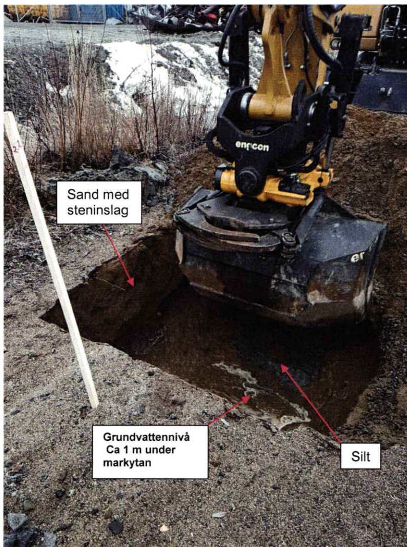
Figur 2. Provpunkt 2 längs spårområde Västerslätt. Denna punkt representerar majoriteten av punkterna längs den aktuella sträckan, dvs 1 m sand med steninslag följt av silt på ca 1m djup.
