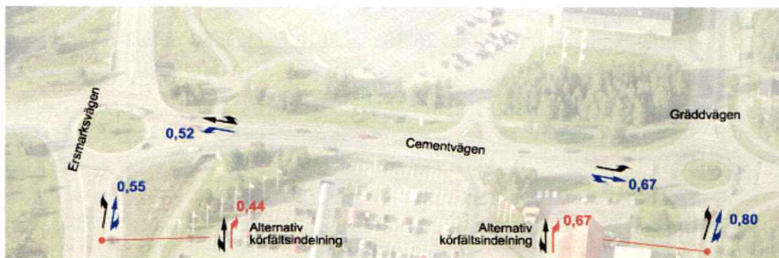
Figur 4-1: Körfält med de högsta belastningsgraderna.
