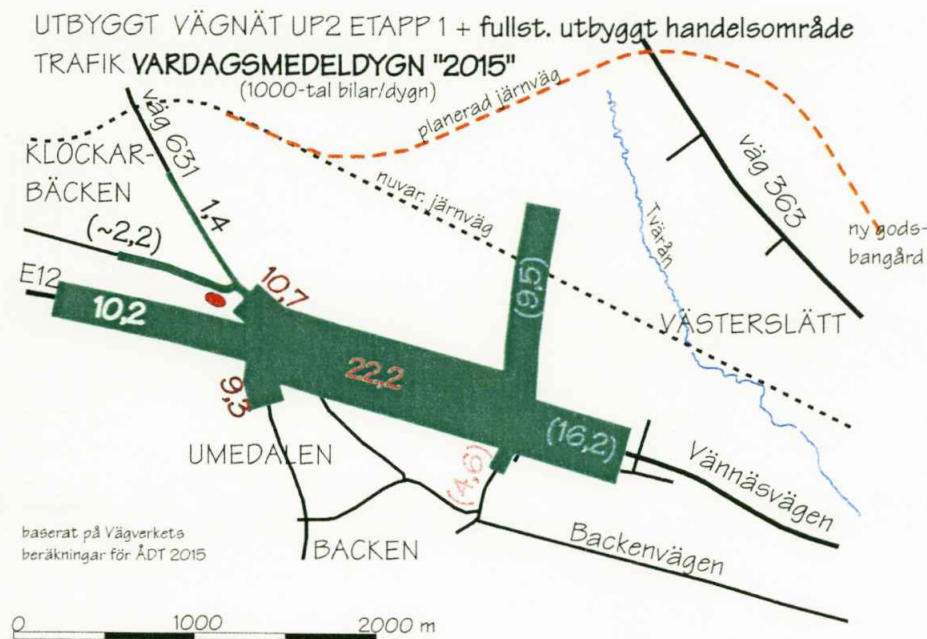
Vardagsdygnstrafik "2015" med utbyggt vägnät (Vägverket, UP2 etapp1) och efter fullständig utbyggnad av handelsområdet.
