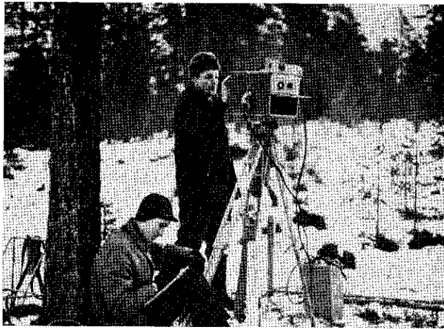
Fig. 2. Längdmätning med geodimeter i Umeå. Foto: I Ekenberg.
